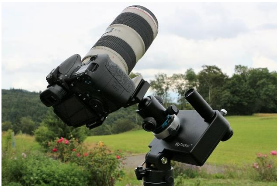
Photo 8 : Monture équatoriale légère et transportable de type iOptron SkyTracker™. Un viseur polaire avec réticule éclairé est bien pratique pour l'orientation précise sur l'axe de rotation terrestre, via l'Etoile Polaire. Le système est capable d'assurer un suivi suffisamment précis avec un réflexe numérique équipé d'un téléobjectif jusqu'à des focales de 300 ou même 400mm.
