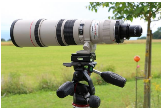
Photo 3 : Le téléobjectif Canon EF 400mm f/5.6 L est équipé d'un adaptateur EOS EF Canon vers le coulant de 1¼" (31.75mm). Cela permet l'installation d'oculaires pour une observation visuelle très agréable. Dans le cas présent, un oculaire orthoscopique de 18mm fournit un grossissement de 400/18=22 fois.
